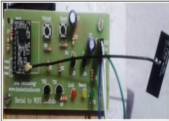
Fig7: Wi-Fi module Esp8266
