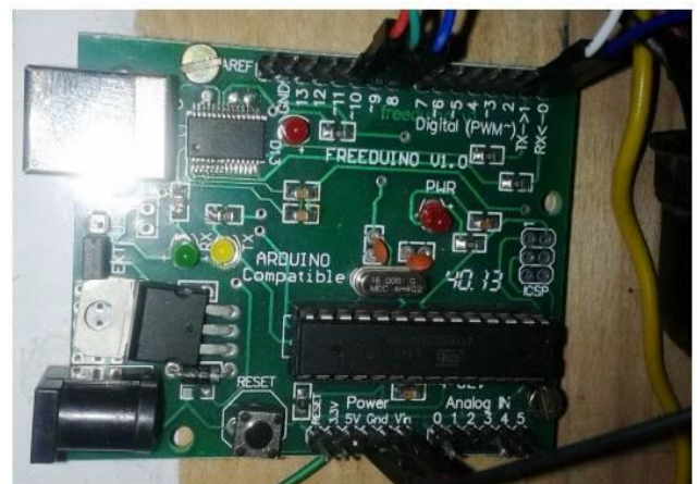
Fig6: Arduino Compatible Freeduino (ATmega328)
