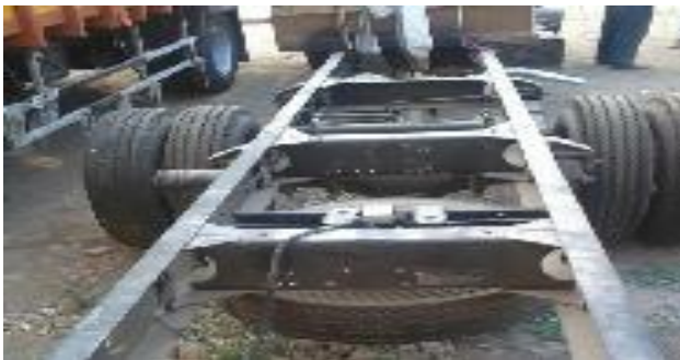
Fig.2. Actual C-beams chassis
